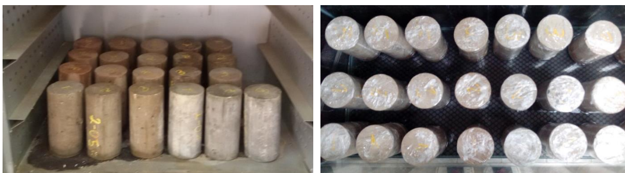
Figura 19 - a) CP na estufa b) CP vedado com filme plástico no recipiente.
