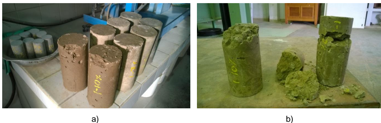
Figura 31 - a) CP a/c 0,65 com 10% de adição de lodo úmido b) CP rompido no faceamento.
