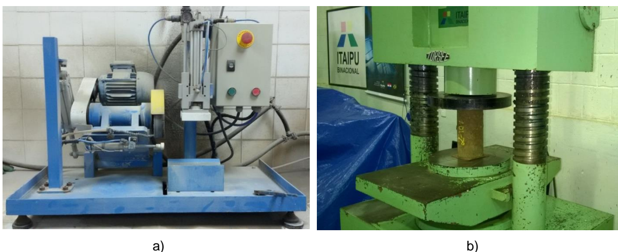
Figura 16 - a) Retificadora de faces do CPs b) Equipamento para ensaio de fc.
