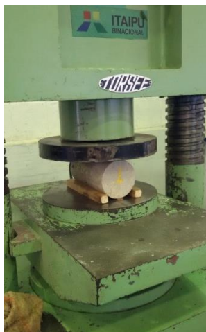
Figura 18 - Ensaio de Compressão diametral.
