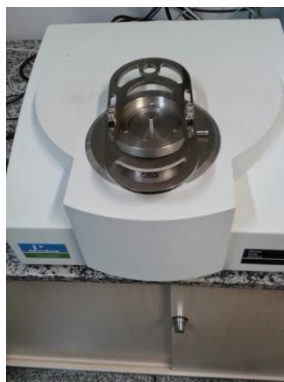
Figura 11 - Equipamento de Análise Térmica Simultânea (TG/DSC).
