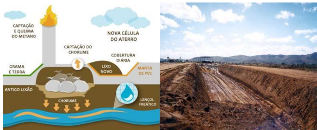
Figura 2 – Esquema e fotografia de um Aterro Controlado Fonte: ECOD, 2010 e SILVA & ALMEIDA, 2010.
