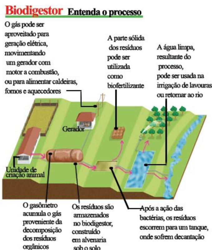
Figura1 – Biodigestor entenda o processo
