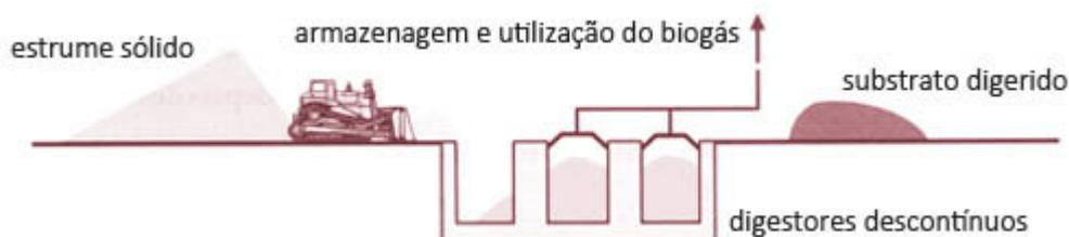
Figura 2 – Sistemas Contínuo ou biodigestor de batelada
