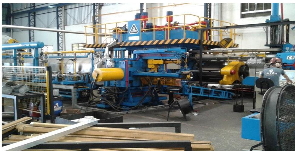
**Figura 3 - Forno de extrusão**
