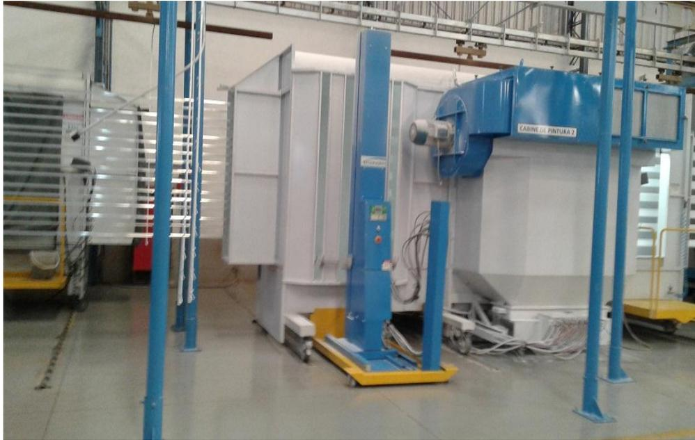
**Figura 8 - Maquinário utilizado para pintura epóxi a pó**
