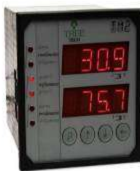
Fotografia 33 – Medidor de temperatura dos enrolamentos - Transformadores a seco.
