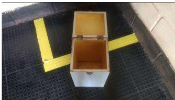
Fotografia 58 – Caixa para armazenamento sem luva isolante Fonte: Autoria própria
