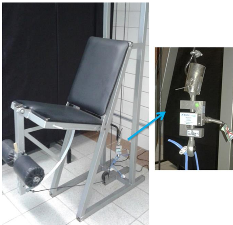
Figura 8: Cadeira extensora adaptada com a célula de carga Fonte: A autora
