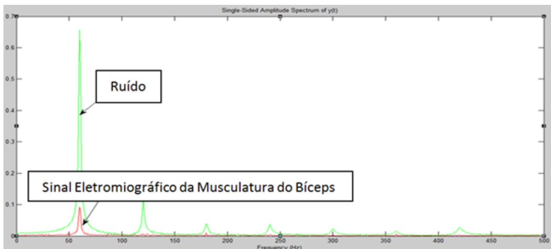
Figura 6: Espectrograma do sinal eletromiográfico com interferência da rede elétrica e de suas harmônicas Fonte: A autora
