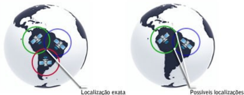
Figura 4 - Modelo de triangulação utilizado pelo sistema de GPS
