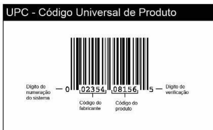
Figura 4 – Estrutura UPC utilizada em produtos com código de barras
