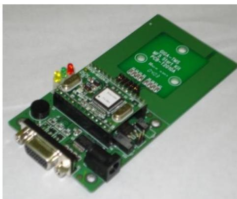
**Figura 3 – Leitor RFID para 13.56MHz**
