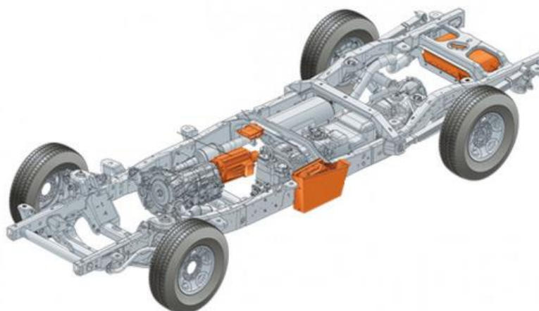
Figura 9 - Exemplo de instalação de um kit de conversão
