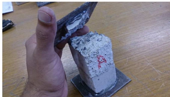
Figura 24. Blocos com argamassa polimérica 1, após os testes.
