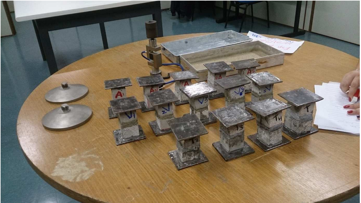
Figura 22: Blocos antes dos testes – Argamassas tradicional, Argamassa polimérica 1 e 2
