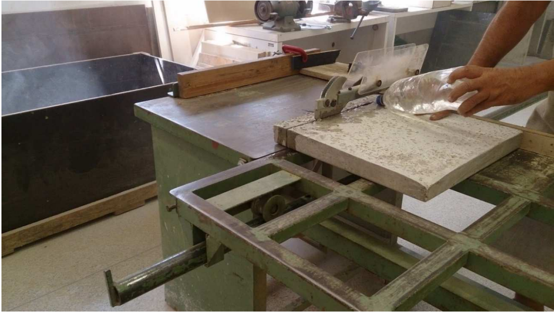
Figura 06. Corte dos blocos com serra de banco
