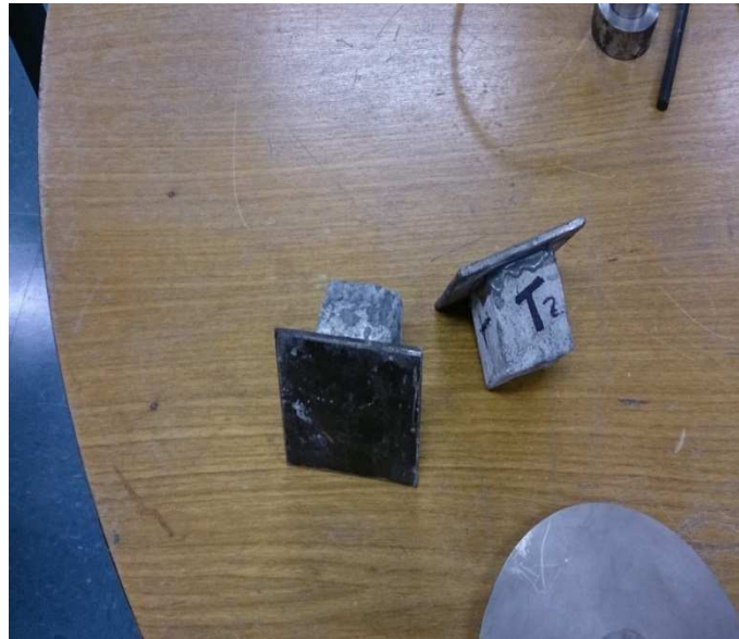
Figura 19. Ruptura do bloco com argamassa tradicional
