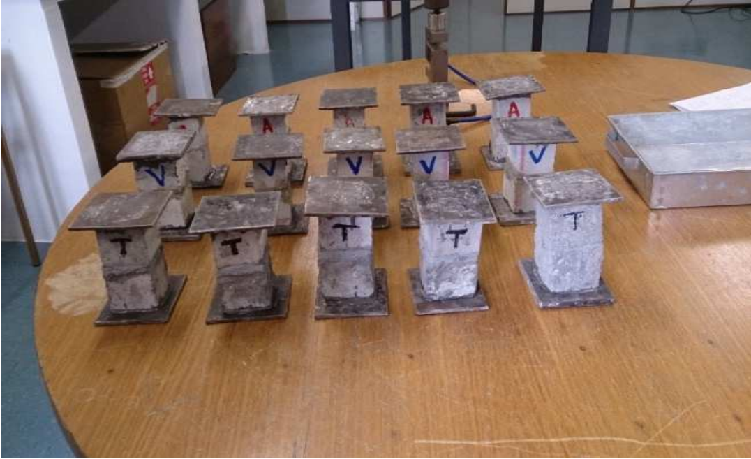
Figura 10. Chapa de aço colada nos corpos de prova
