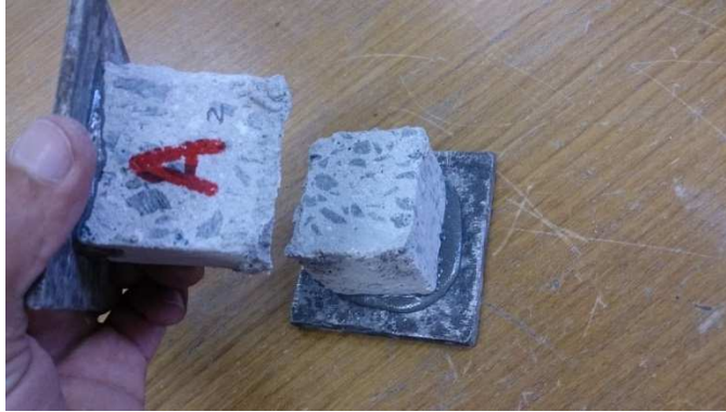
Figura 20: Ruptura de bloco com Argamassa polimérica 1
