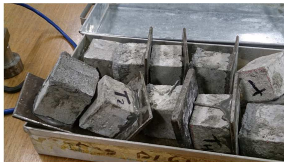
Figura 23. Blocos com argamassa tradicional após os testes
