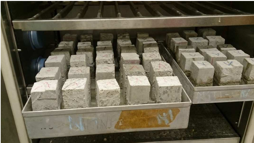
Figura 14: Blocos na câmara térmica (a)
