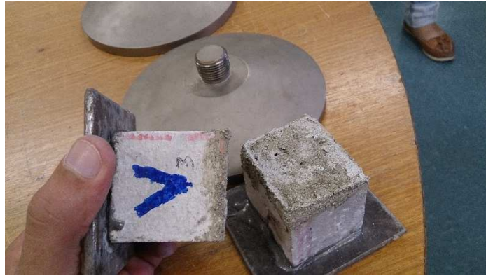
Figura 21: Ruptura de bloco com argamassa polimérica 2.
