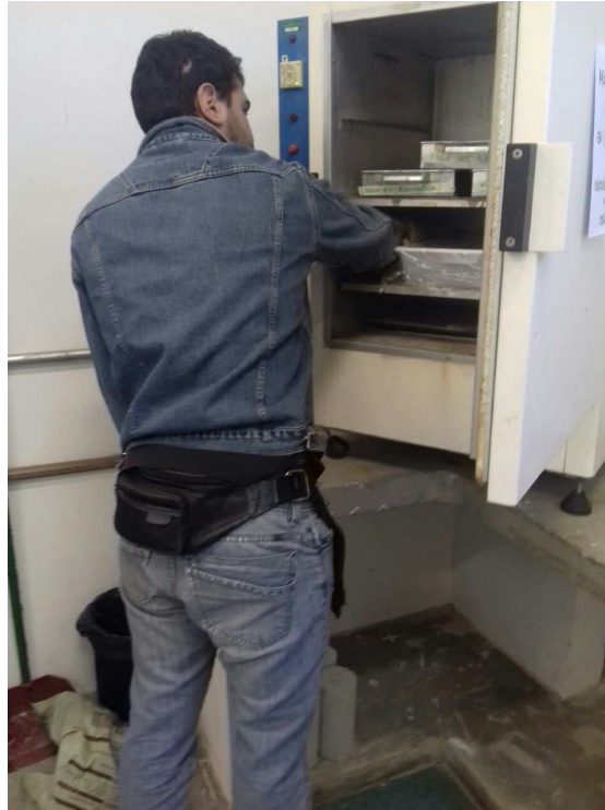
Figura 18: Forno para secagem dos blocos
