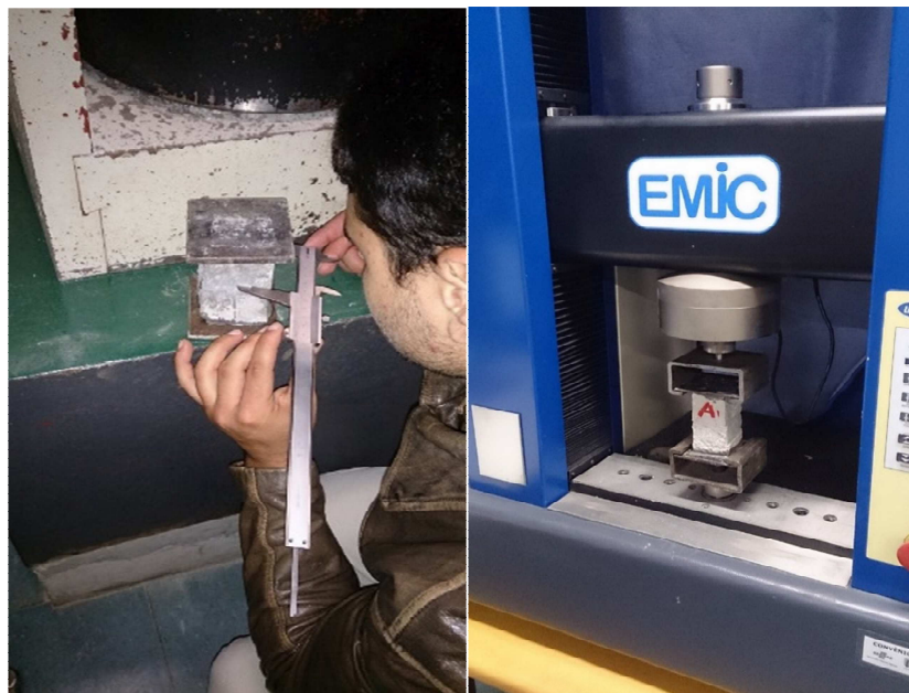
Figura 12: Medição da Área dos blocos e Prensa hidráulica EMIC
