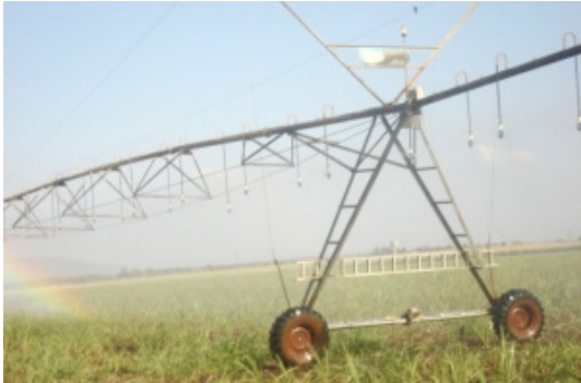
Figura 2 – Irrigação por aspersão por meio de pivô-central
