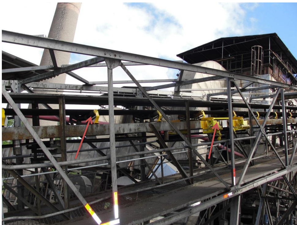
Figura 4 – Balança (depois) com roletes, tacômetro e saídas para comunicação de dados.
