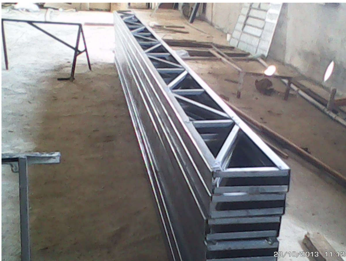
Figura 06: Pilar metálico treliçado Fonte: Acervo do autor (2016)
