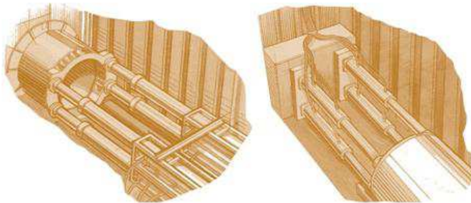
Figura 32 - Pistões hidráulicos Fonte: PJA (2016)
