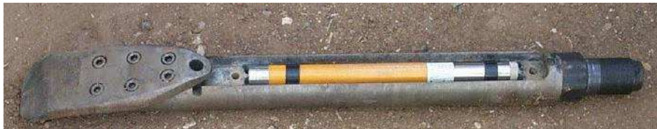
Figura 23 - Ferramenta de corte com sonda eletromagnética Fonte: Nepomuceno (2008)
