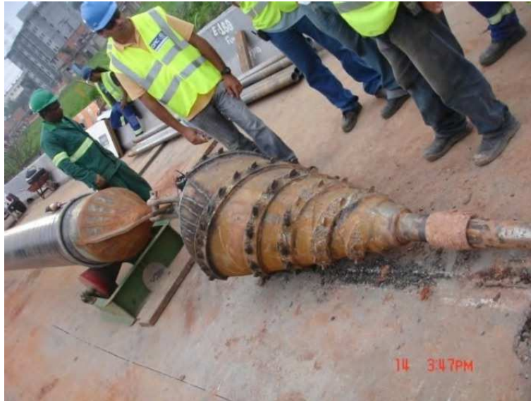
Figura 28 - Alargador com conexão articulada Fonte: ABRATT (2007)
