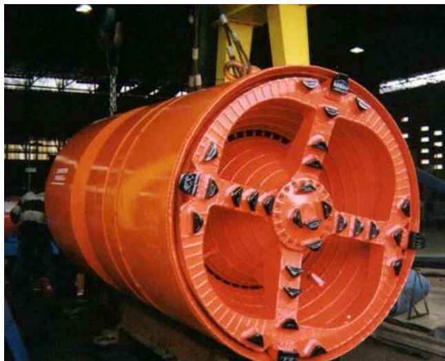
Figura 33 - Cabeça cortante desagregadora Fonte: Calça (2007)
