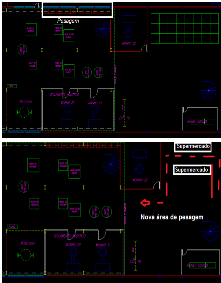
Figura 13– Comparação de Layout da pesagem a.) Layout anterior. b) Layout novo. Fonte: WEG TINTAS, (2016).
