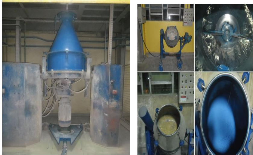
Figura 11 – a) misturador capacidade acima de 50 kg, b) misturador de capacidade até 50 kg. Fonte: WEG TINTAS, (2016).
