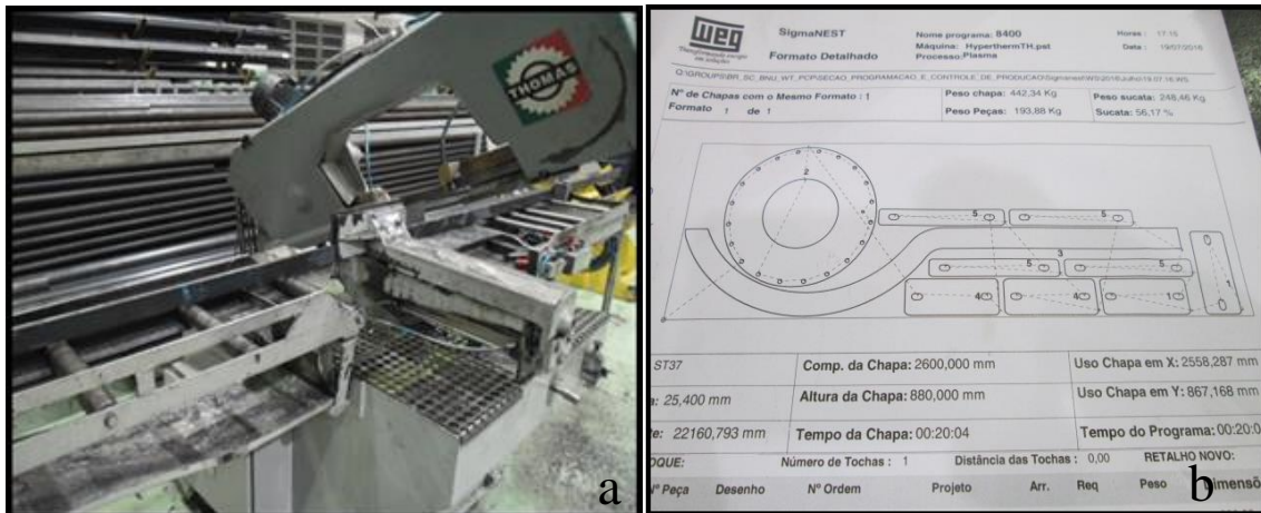
Figura 3a: Serra fita e 3b Programa de corte Fonte: Autoria própria.
