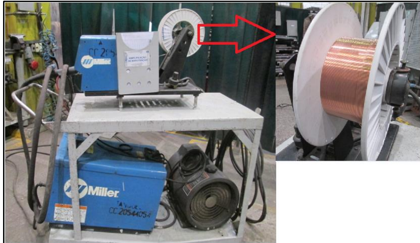
Figura 11: Máquina de solda com bobina de 50mts de arame de solda Fonte: Autoria própria.
