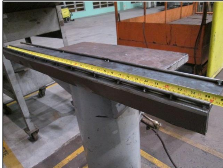
Figura 9: Corpo de prova do flange Fonte: Autoria própria.
