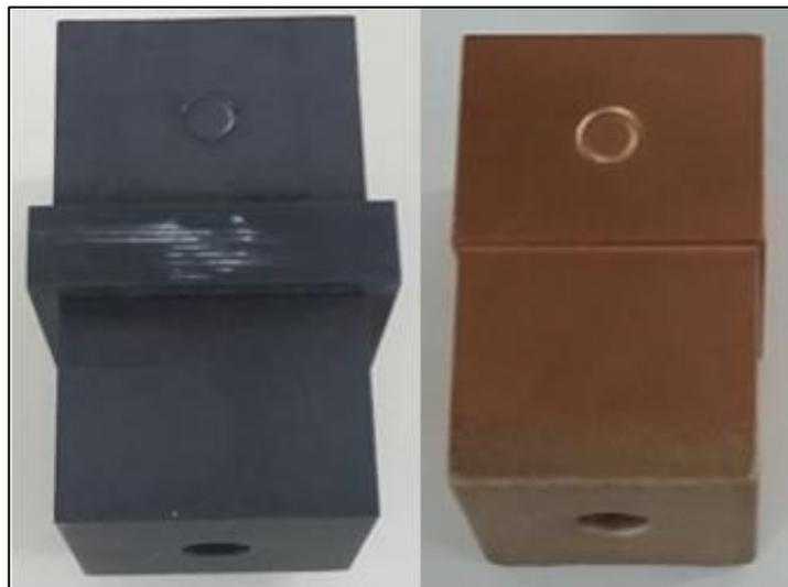
Figura 19: Eletrodos para o teste de grafite e de cobre
