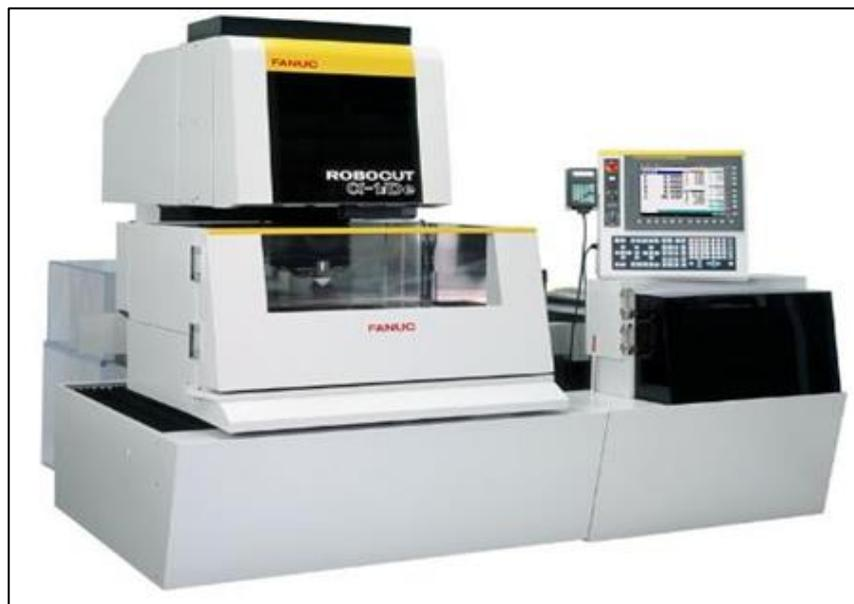
Figura 02: Máquina eletroerosão a fio
