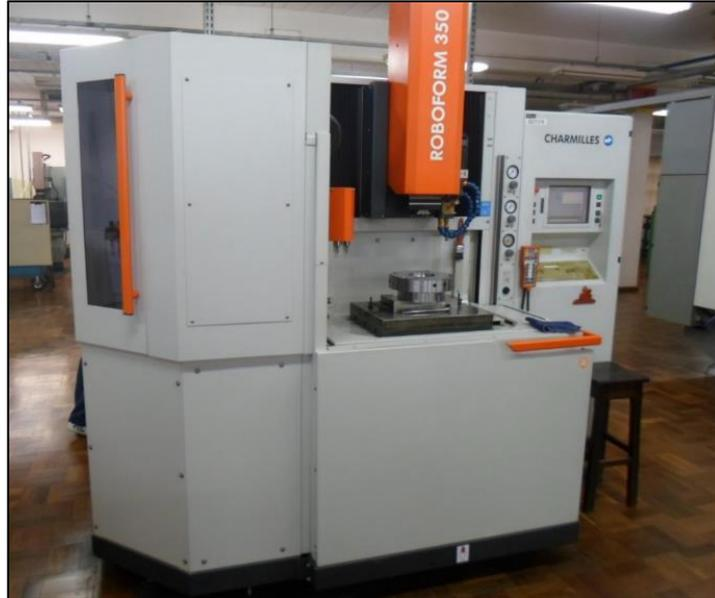
Figura 58: Máquina de eletroerosão por penetração para teste comparativo entre cobre e grafite
