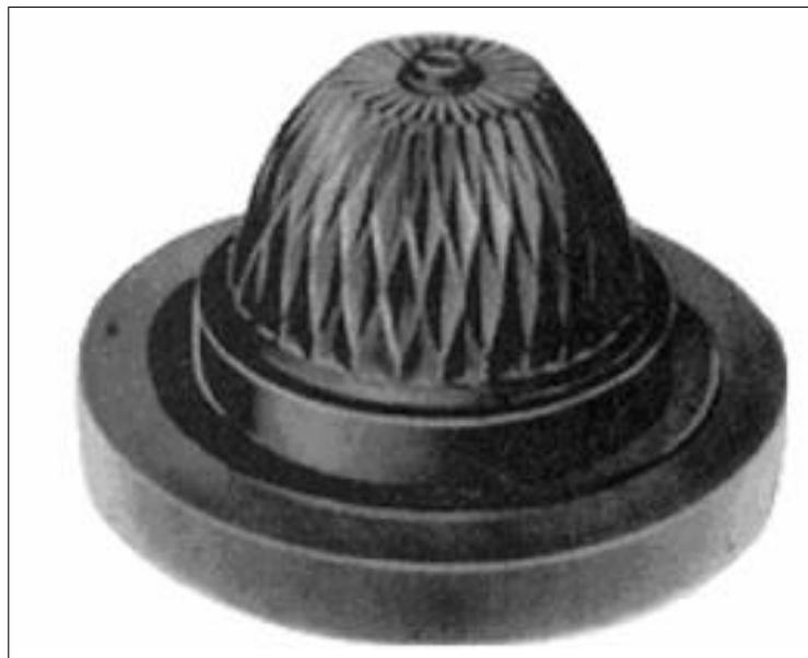
Figura 07: Eletrodo de grafite usinado
