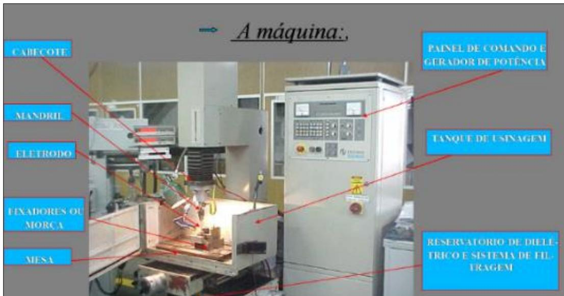
Figura 03: Partes da eletroerosão por penetração
