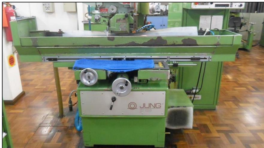
Figura 12: Retífica Jung utilizada para esquadrear corpo de prova
