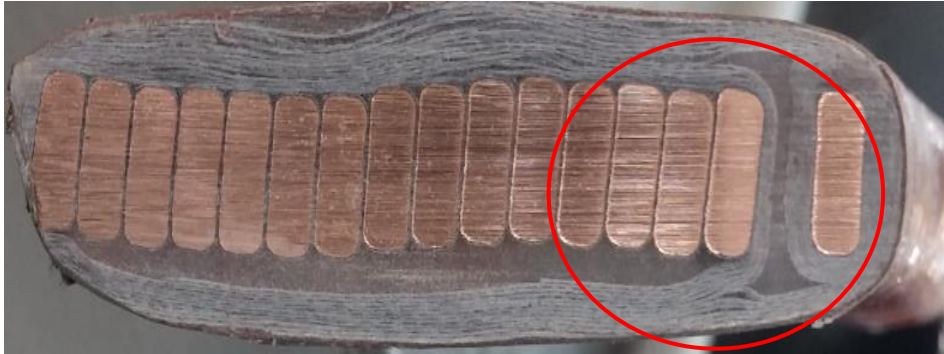
Figura 14 - Bobina (2-1, 2-2 e 2-3)* com isolação manual + feltro catalisado Fonte: Autoria própria.
