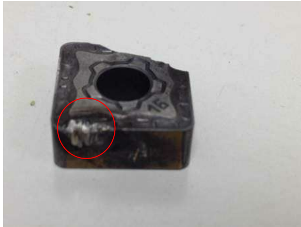
Figura 6.2 - Pastilha com desgaste de cratera
