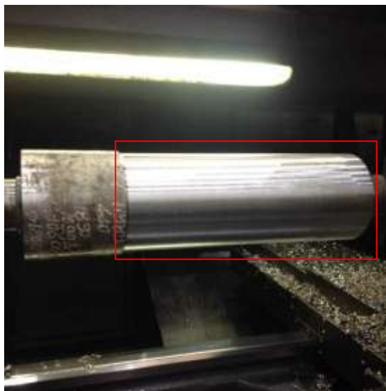
Figura 6.3 - Superfície desbastada usinada parcialmente
