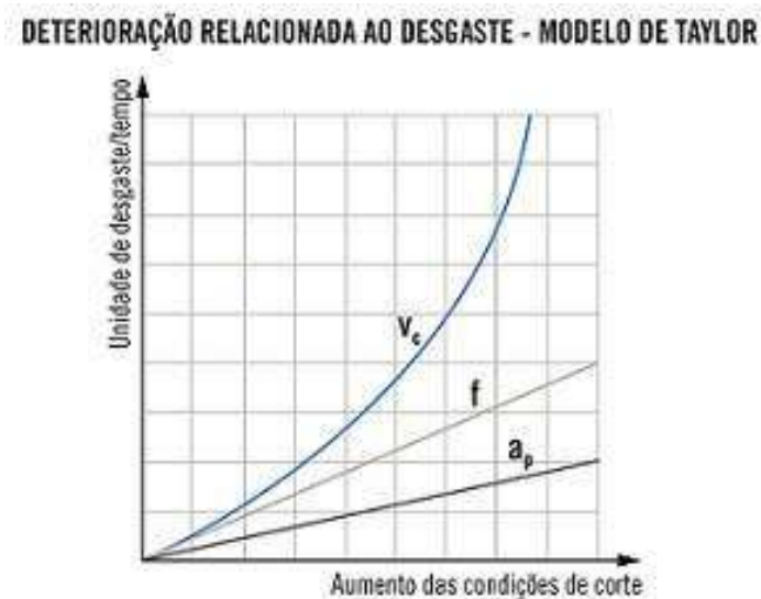
Figura 3.6 - Desgaste da ferramenta de corte em função da velocidade de corte ( V_c ), avanço ( f ou f_n ) e profundidade de corte ( a_p )
