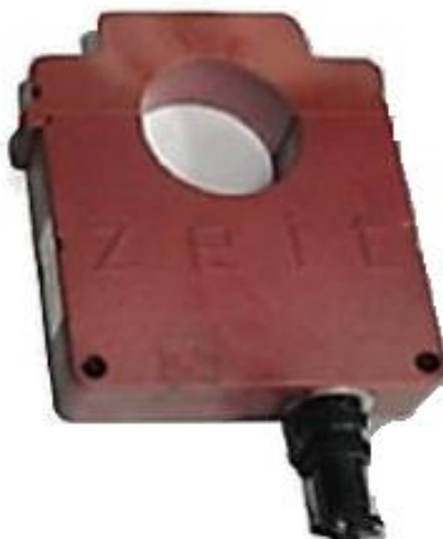
Fotografia 4.2 – Transdutor de corrente dos motores de tração
