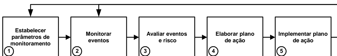
Figura 2.2 - Processo genérico e de alto nível para avaliação contínua da segurança de acordo com a ARP 5150
