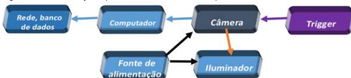
Figura 2.2 – Instalação típica da câmera estudada por este trabalho.
