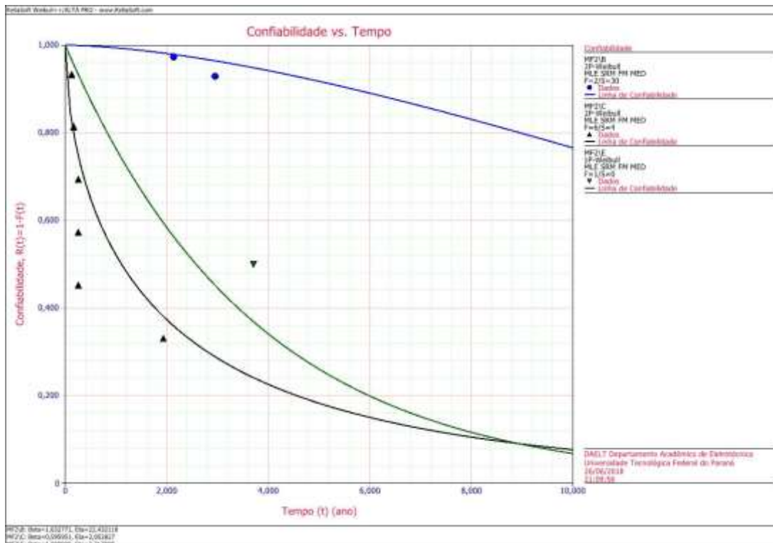
Figura A.2 – Confiabilidade para o modo de falha “MF2”, clientes B, C e E.
