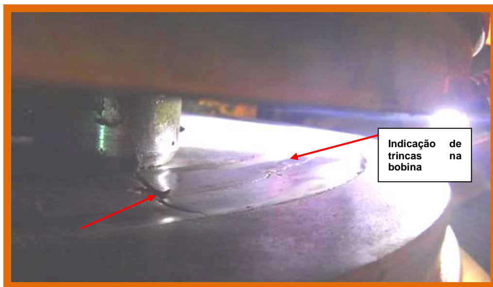
Figura 2. 8 - Bobina com trinca identificada durante peritagem do freio
