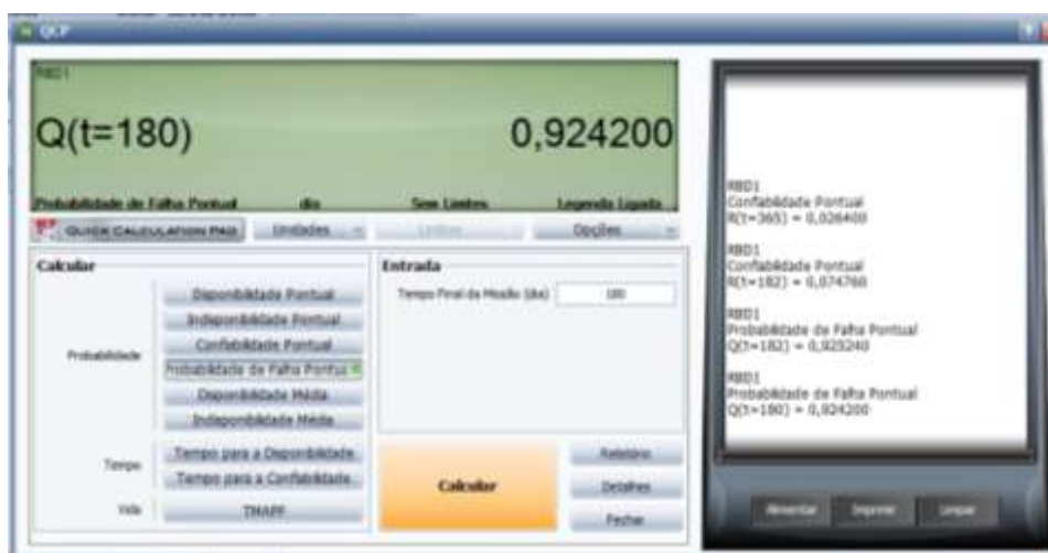
Figura 4. 16 - Calculadora do módulo Weibull++ com resultado da probabilidade de falha pontual do sistema LDA
