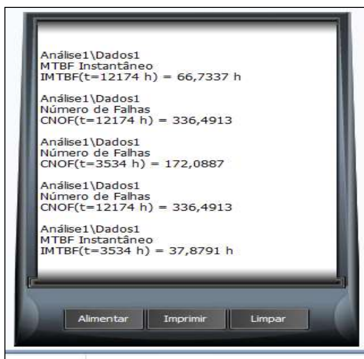
Figura 4.1: Imagem do Realiasoft RGA com as simulações de MTBF e quantidade de falhas esperadas no tempo de 12.174 horas
