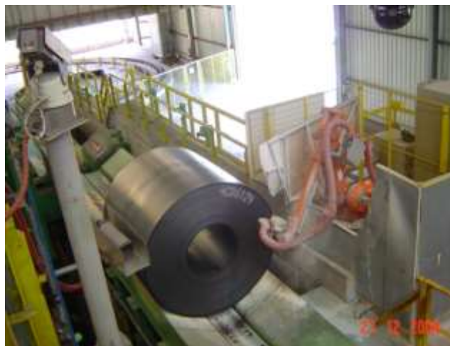
Figura 2.17: Máquina de marcar identificando a bobina sobre o WB1.
