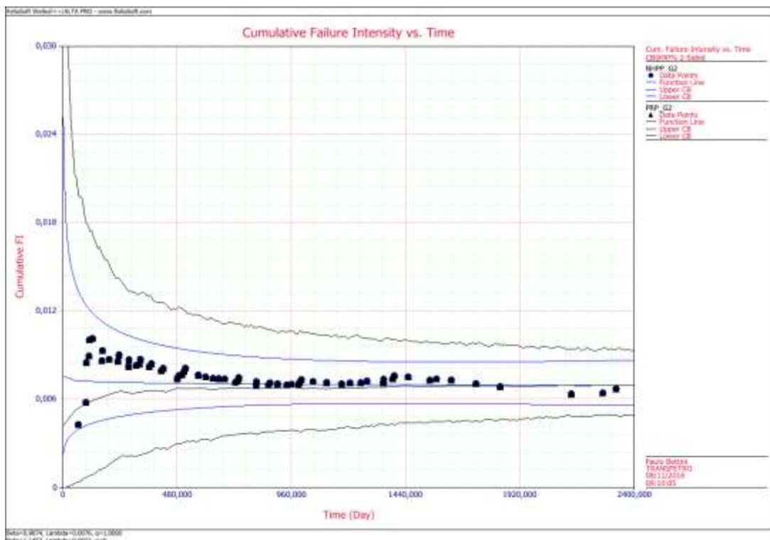
Figura 19 - Intensidade de Falha Acumulada por modelo para Grupo II Fonte: Autoria própria
