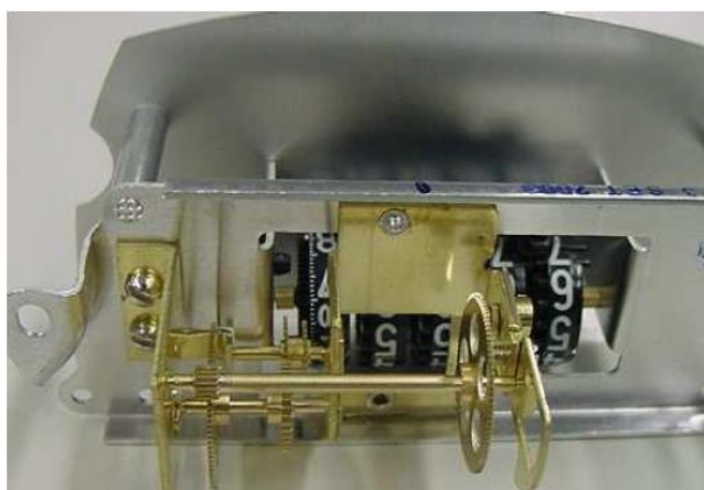
Figura 5 Registrador de consumo do medidor eletromecânico
