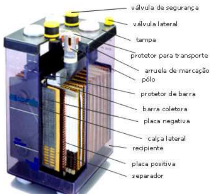
Figura 1: Vista interna de uma bateria chumbo-ácida de fabricação Teleco
