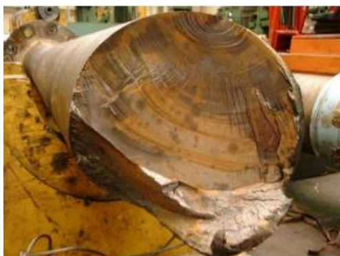
Figura 2: Fratura por fadiga de um eixo de transmissão. Fonte: Lassen & Spagnoli
