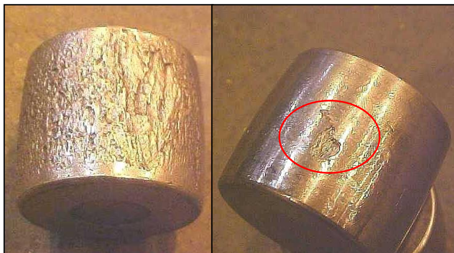
Foto 8 – Deformações nos elementos rolantes do rolamento Fonte: Autoria própria.
