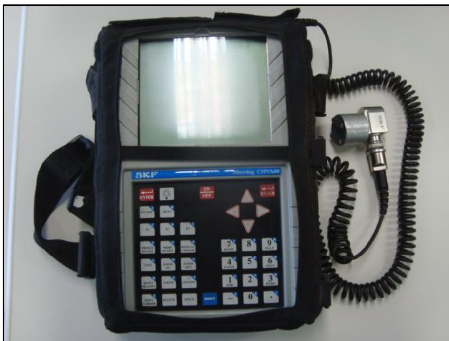
Foto 2 – Coletor e analisador de vibrações da SKF Microlog CMVA 60 Fonte: Autoria própria.
