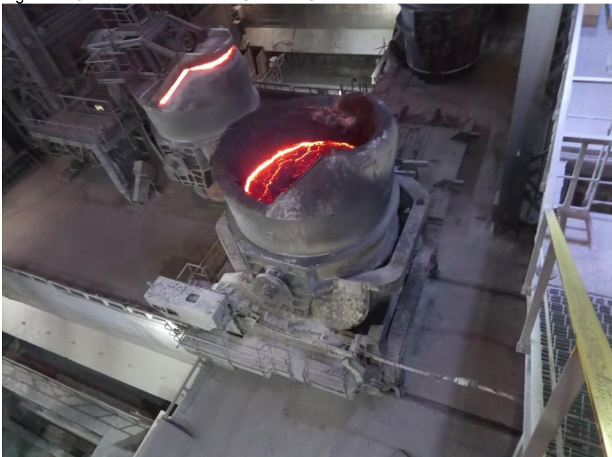
Figura 4.18 - Vista da Panela de Gusa no Carro
