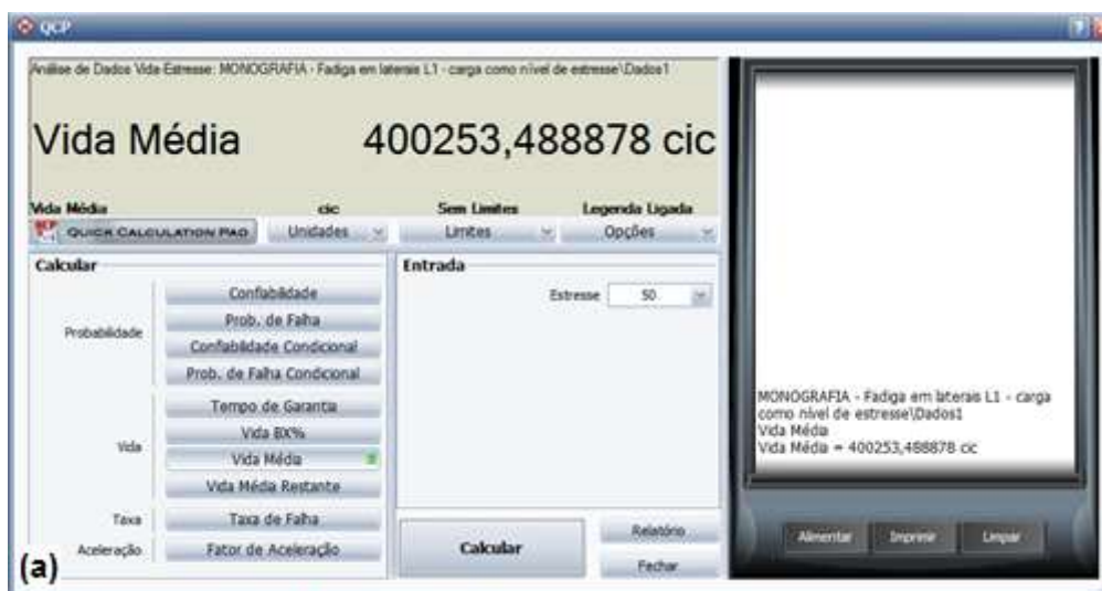
Figura 4.10 – Vida média remanescente das laterais tipo 1 (a) e tipo 2 (b)
