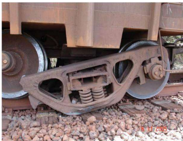
Figura 1.4 – Lateral ferroviária com pedestal quebrado
