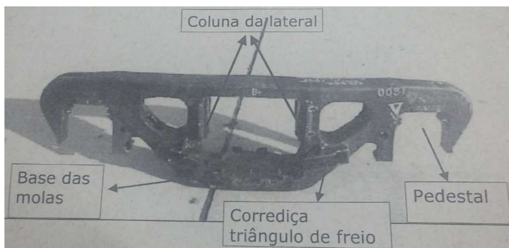
Figura 1.2 – Lateral ferroviária e suas partes
