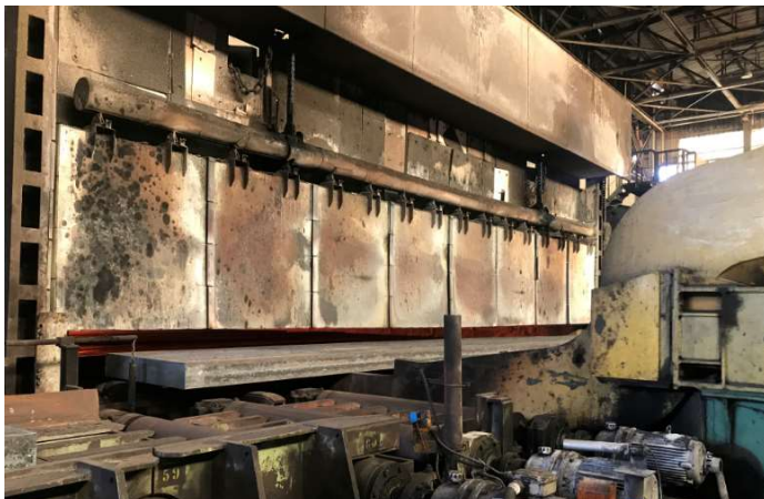
Figura 2.5 – Carregamento de Placas nos Fornos
