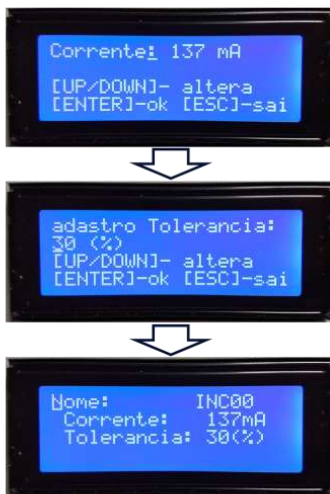
Fotografia 4.3 – Programação da corrente elétrica na bancada de teste
