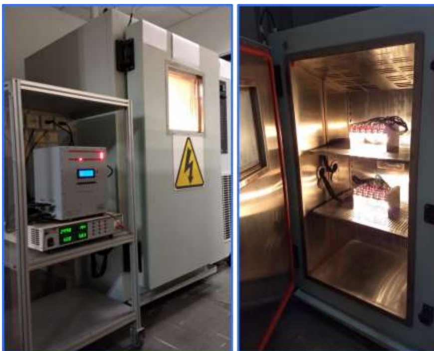
Fotografia 4.4 – Bancada de teste e fonte de alimentação AC (Teste térmico)
