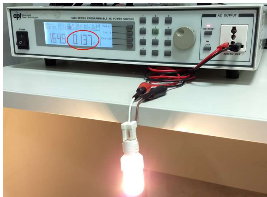
Fotografia 4.2 – Medição de corrente elétrica na tensão elétrica de teste
