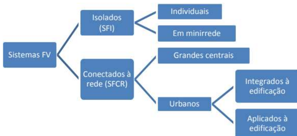
Figura 6 – Tipos de sistemas fotovoltaicos
