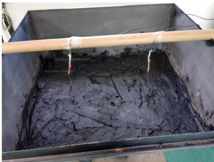
Figura 28 - Fixação dos termopares nos protótipos Fonte: Aatoria própria.
