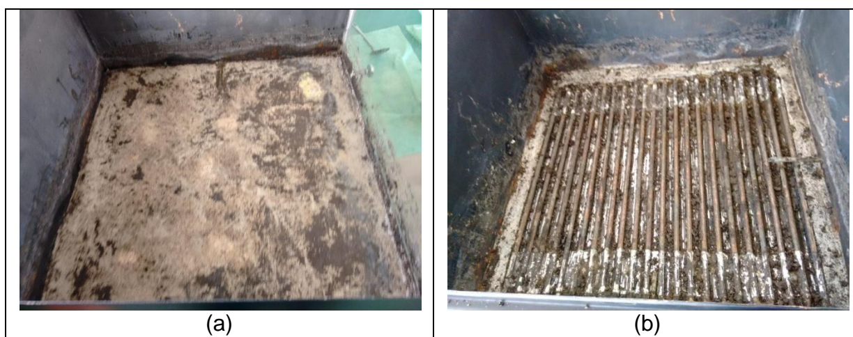
Figura 61 – Fotografia dos protótipos após a retirada do lodo de esgoto: (a) Protótipo 1; (b) Protótipo 2
