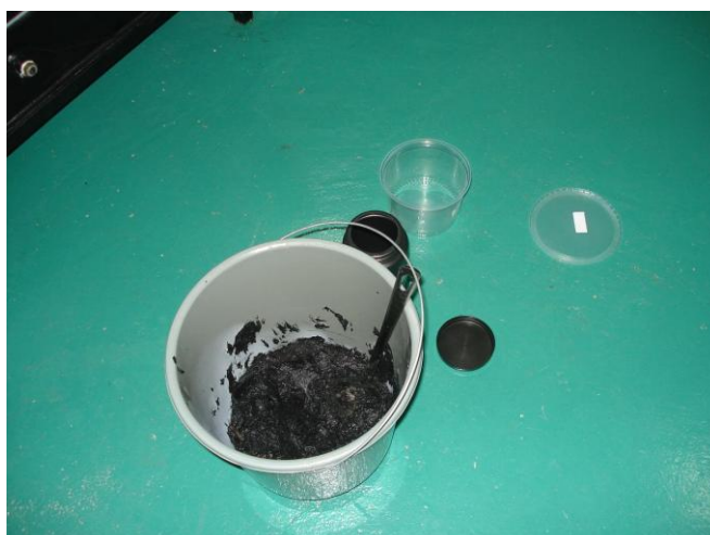
Figura 30 - Coleta de amostras de lodo de esgoto Fonte: Autoria própria
