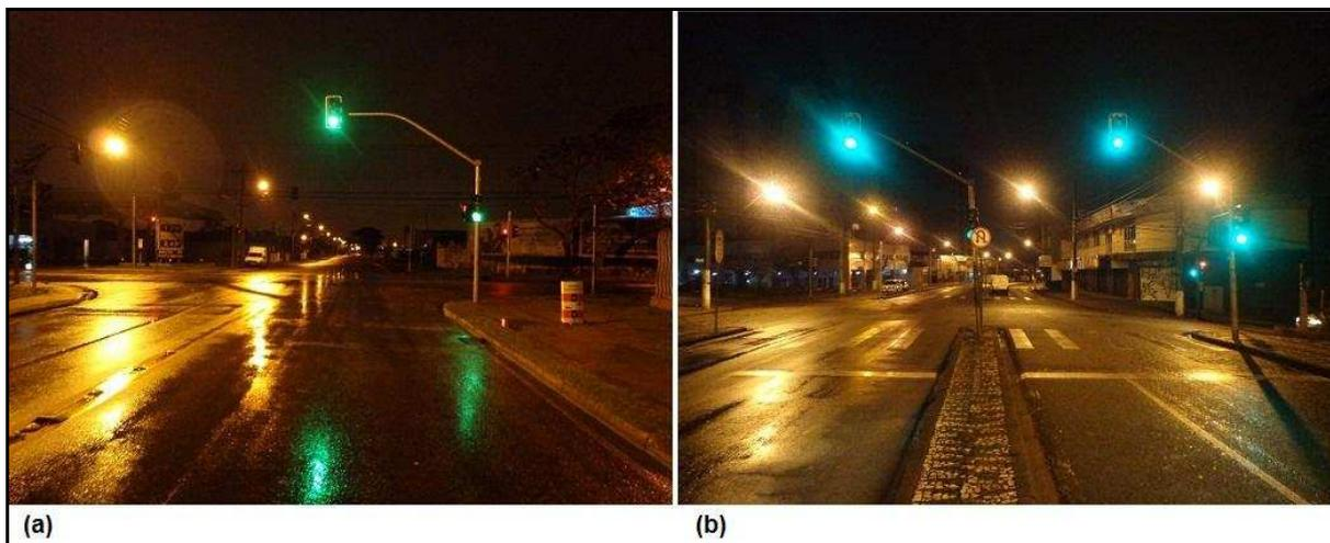
Figura 14 – Aspecto visual de semáforo com iluminação lâmpada incandescente (a) e *LED* (b)
