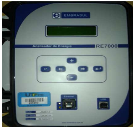
Fotografia 3.8: Analisador de Energia RE7000. Fonte: Autor.
