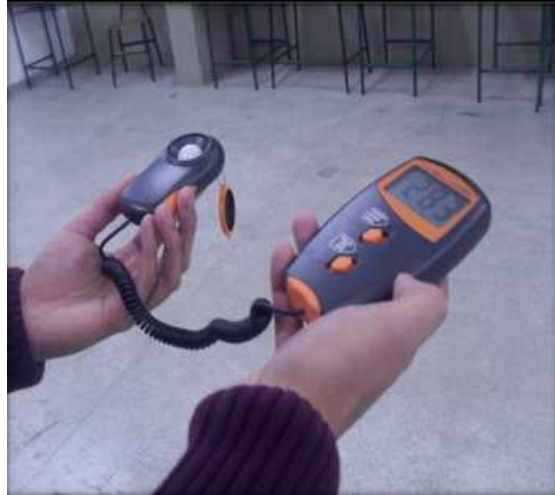
Fotografia 3.3: Medição da Iluminância Mantida. Fonte: Autor.
