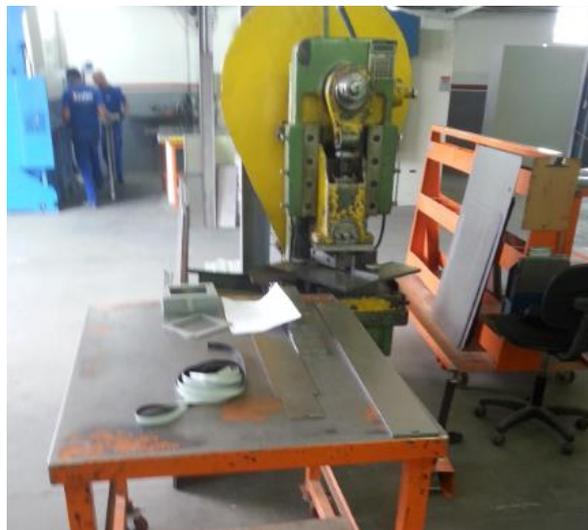
Figura 17: Prensa excêntrica: espaço ao redor da máquina
