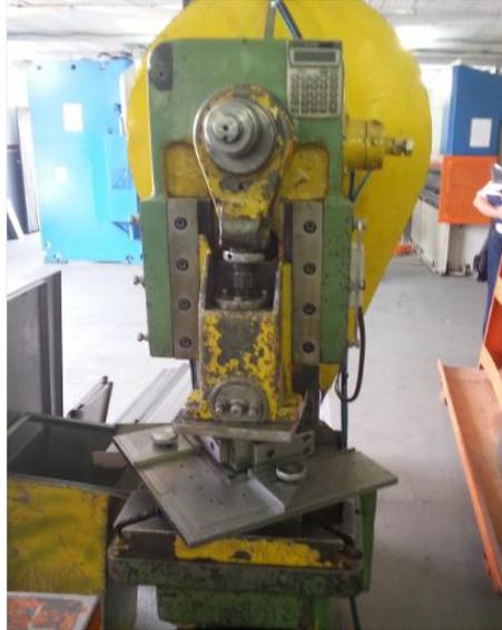
Figura 16: Prensa excêntrica: visão geral
