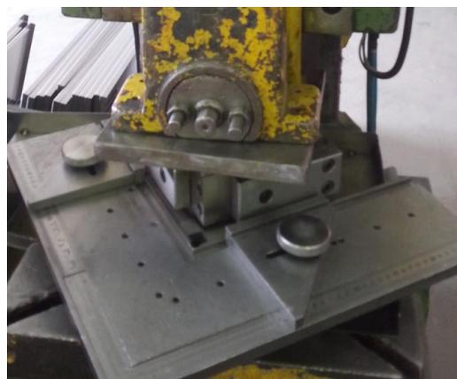
Figura 19: Prensa excêntrica: partes móveis e perigosas
