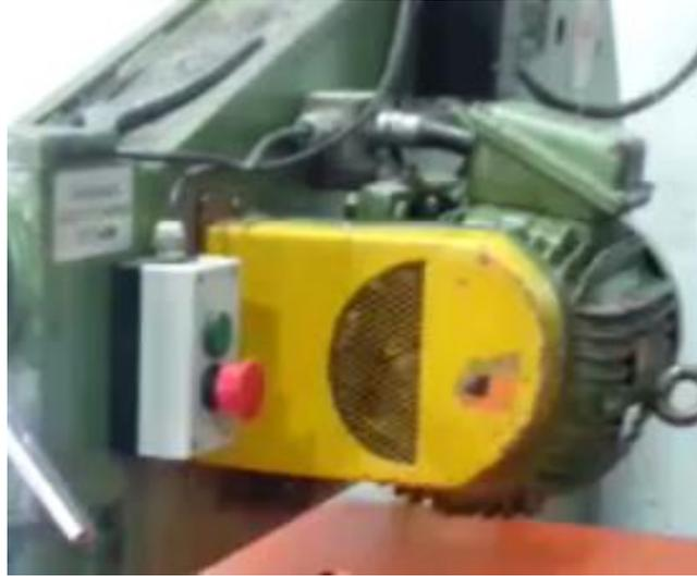
Figura 13: Puncionadeira FRANHO: Proteção fixa adaptada
