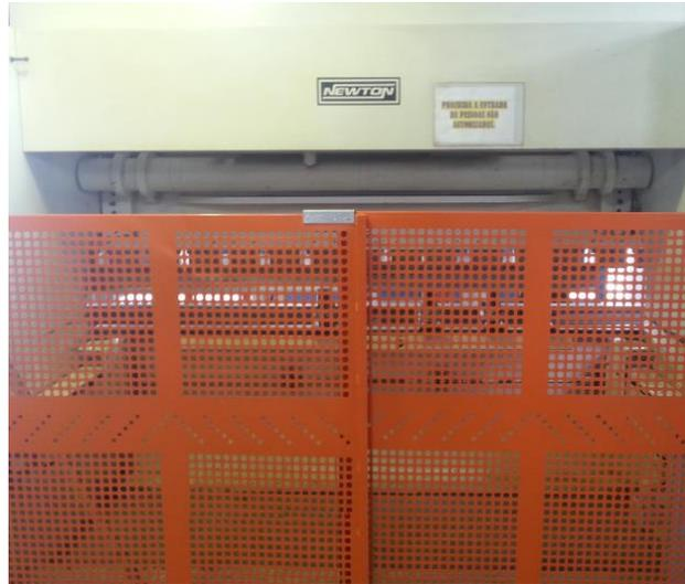
Figura 6: Dobradeira: proteção móvel
