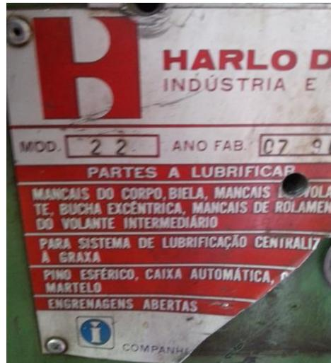
Figura 18: Prensa excêntrica: Instrução de manutenção
