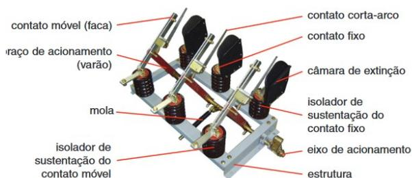
**Figura 8 – Componentes da chave seccionadora (abertura sob carga).**
