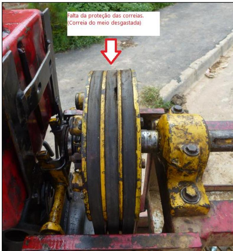
Figura 4, Ausência de proteção das correias.
