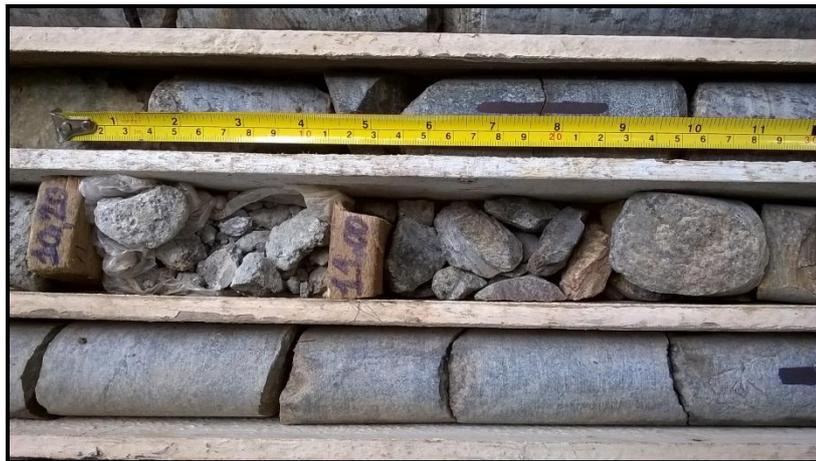
Figura 2, Amostras cilíndricas de sondagem rotativa.
