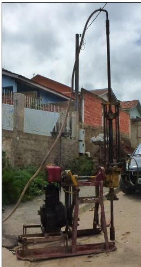
Figura 3, Sonda rotativa Mach 920.
