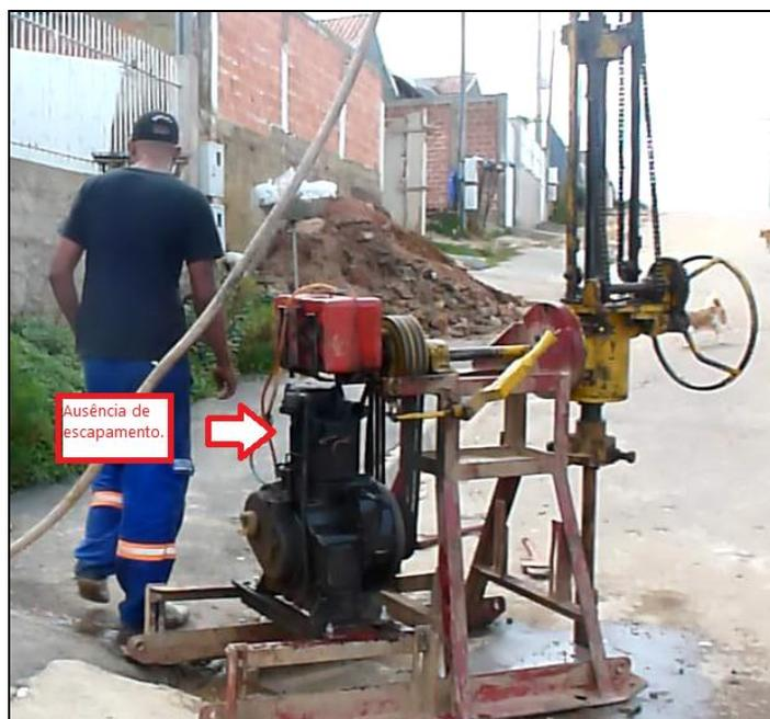
Figura 5, Ausência de escapamento e auxiliar sem EPIs.
