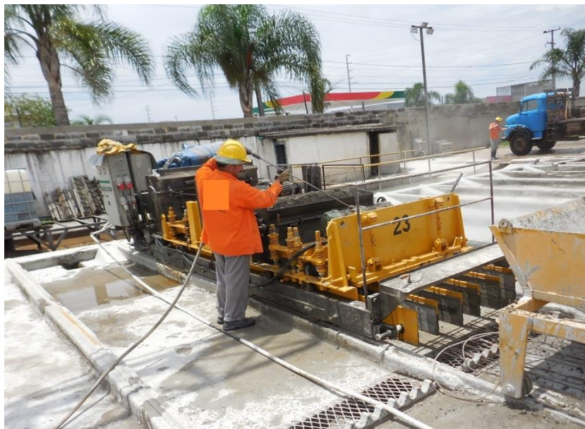
Figura 11 - Limpeza da Máquina Moldadora Fonte: Autor
