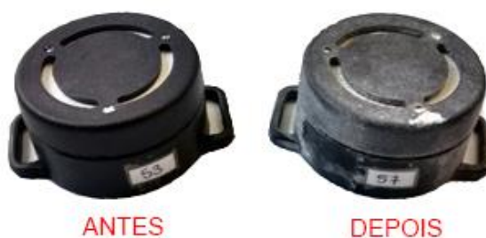
Figura 12 - Câmaras com detectores CR-39 antes e após exposição Fonte: Autor
