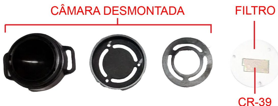
Figura 11 - Câmara de difusão e detector CR-39 Fonte: Autor
