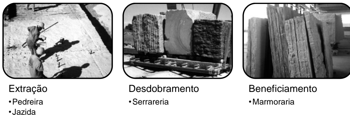
Figura 3 - Etapas produtivas da indústria de mineração Fonte: Adaptado de Spínola et al. (2004)
