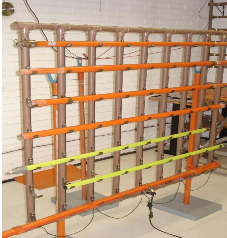
FIGURA 16 – TESTE EM VARA DE MANOBRA
