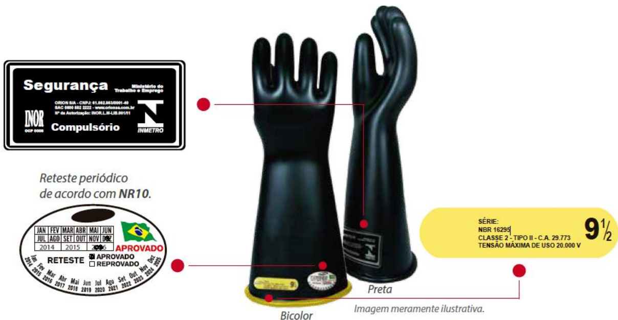
FIGURA 13 – MARCAÇÕES NA LUVA DE BORRACHA
