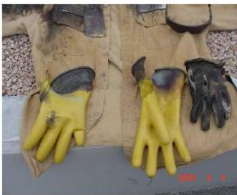
FIGURA 8 – ARCO ELÉTRICO PROVOCADO POR UM CURTO CIRCUITO
