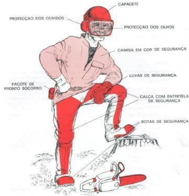
Figura 3: Equipamentos de Proteção Individual.
