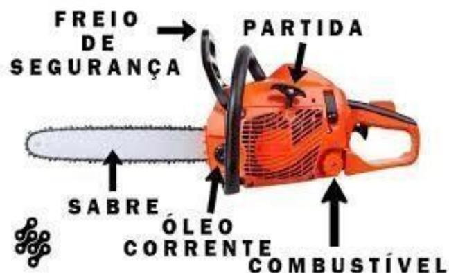
Figura 2- Funcionamento da Motosserra
