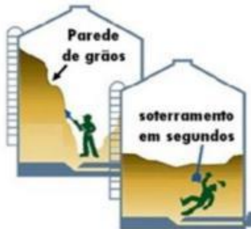
Figura 1 – Risco de soterramento em silos Fonte: ACCA, 2011.
