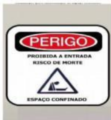
Figura 4 - Sinalização de um espaço confinado como os silos e armazenamentos de grãos Fonte: Anexo II da norma NR 33 (BRASIL, 2017)
