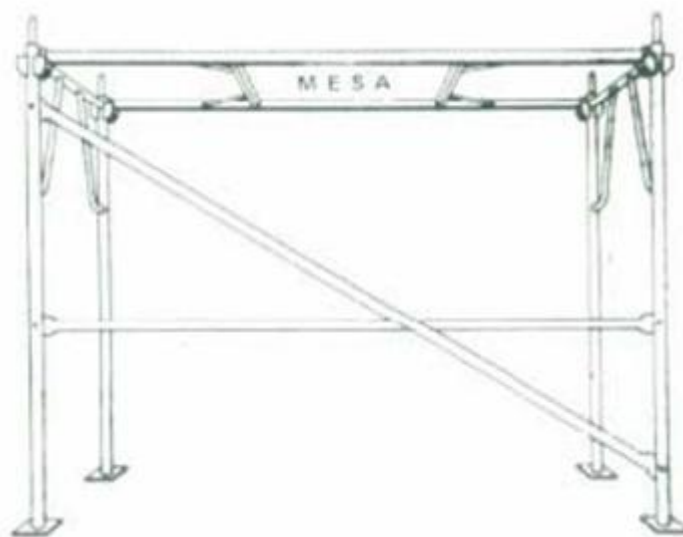
Figura 15. Andaime simplesmente apoiado. Fonte: PMS (2009).
