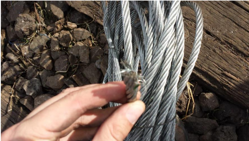
Figura 3 – Cabo de aço 8mm.
