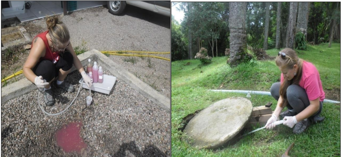
Figura 6 A e 6 B Coleta do efluente bruto e na parte superior da estação. Fonte Autora
