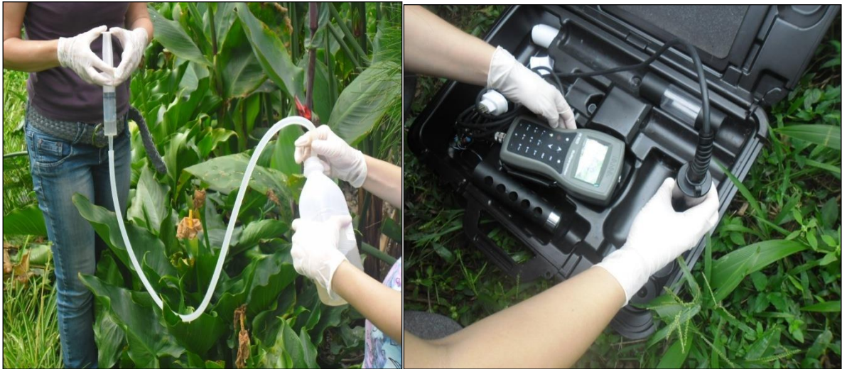
Figura 8- A. Coleta de efluente tratado. B- Uso da sonda multiparâmetros. Fonte: Autora
