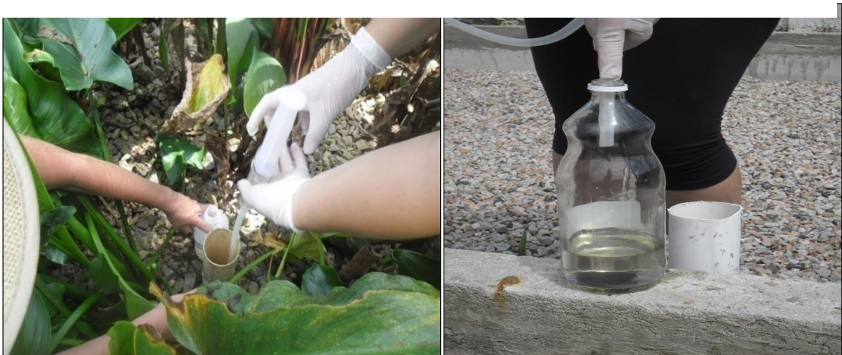
Figura 7. A- Coleta do esgoto tratado no cano de respiro. B- Efluente tratado. Fonte: Autora
