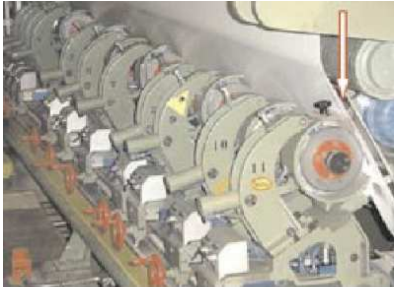
Figura 8. Foto ilustrativa das facas de corte de uma enroladeira.
